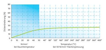
Die Empfehlungen für Temperatur und Druck in den Diagrammen gelten für eine Dichtungsdicke von 2,0 mm und bei Verwendung glatter Flansche. Bei Einsatz dünnerer Dichtungen sind höhere Beanspruchungen möglich!
